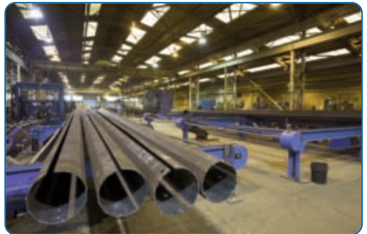
Secciones de tubos formados recién fabricados en la nueva prensa aguardan su paso por la nueva soldadora de costuras longitudinales. Las secciones formadas son trasladadas de la prensa a la soldadora longitudinal en una mesa transbordadora diseñada y construida por empleados de T&B.
