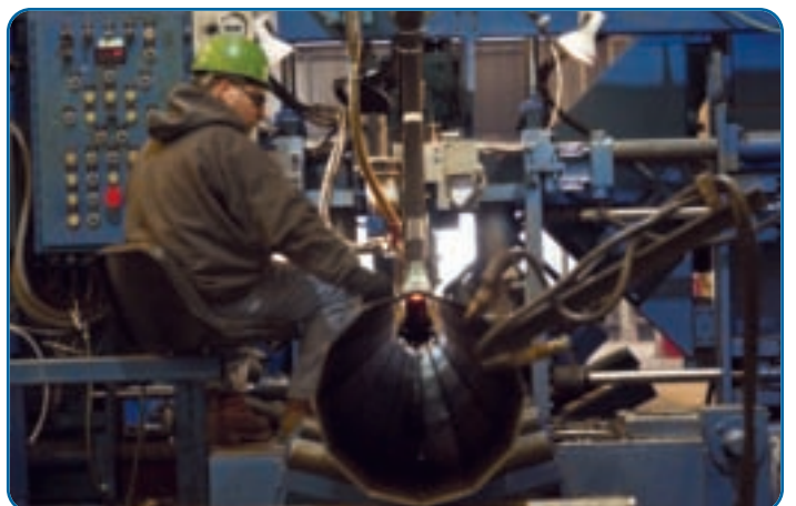
Jeff Sigmon supervisa la nueva soldadora de costuras para verificar la calidad superior de las soldaduras.
