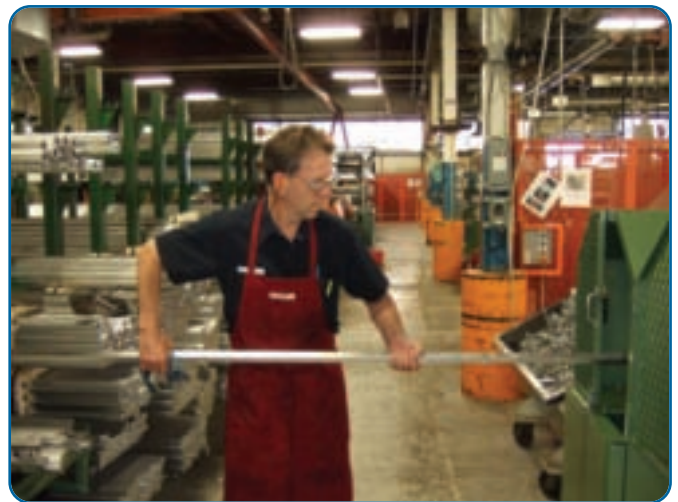
Yves Leblanc, operario de maquinaria, demuestra cómo se introduce en la máquina la barra de aluminio de 12 pies de longitud.
