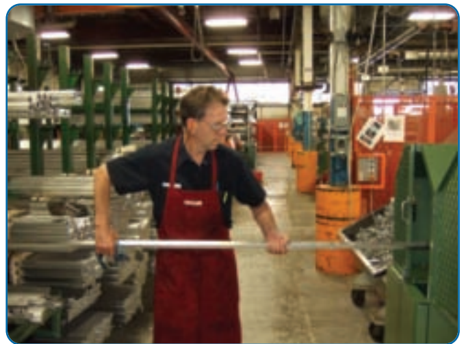
Yves Leblanc, opérateur de machinerie, démontre comment une barre d'aluminium de 12 pieds est insérée dans la machine.
