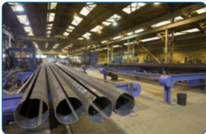
Des sections tubulaires fraîchement formées dans la nouvelle presse, en attente de passer dans la nouvelle jointeuse longue. La section formée passe de la presse à la jointeuse longue sur une table de transfert conçue et construite par des employés de T&B.
