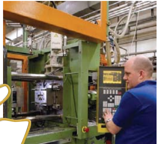
Arriba: Prav Mistry, ajustador de máquinas, inspecciona un convertidor de rosca Kopex-Ex que se fabrica en una máquina de control numérico computarizado (CNC, por sus siglas en inglés) en la planta de Coleshill Birmingham. Una máquina CNC se utiliza para fabricar piezas metálicas para todo uso, desde piezas de autos hasta piezas de construcción.
