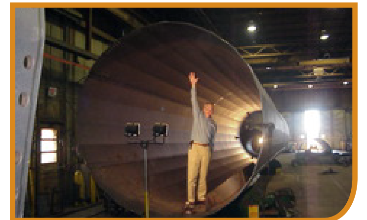
La nueva prensa en tándem larga de Hager City aplana placas de acero en tubos poligonales de 12 y 16 caras, parte esencial del proceso de fabricación de postes de transmisión eléctrica. En la foto aparece Bob Schultz, vicepresidente de ventas y marketing de la división de Estructuras de Acero de T&B, ya jubilado.
