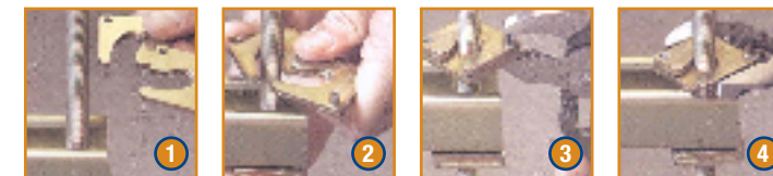
L'attache Trapnut s'installe en un clin d'œil. 1) Tenez-la en position ouverte. 2) Insérez la plaque inférieure sur la tige et fermez la plaque supérieure. 3) Serrez les pattes avec une pince. 4) Serrez à la position désirée.
