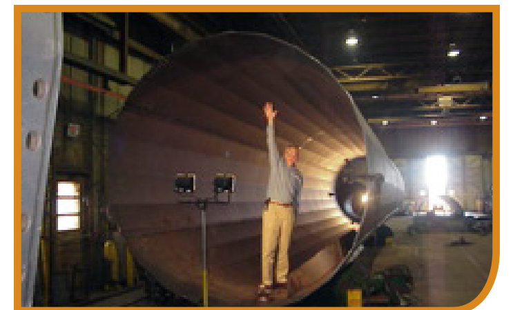
La nouvelle presse tandem longue de l'usine d'Hager City plie des plaques d'acier en tubes polygonaux de 12 ou 16 côtés, une opération critique dans le processus de fabrication des pylônes électriques. Sur la photo, on aperçoit Bob Schultz, alors vice-président des ventes et du marketing au sein de la division des structures d'acier T&B et maintenant à la retraite.
