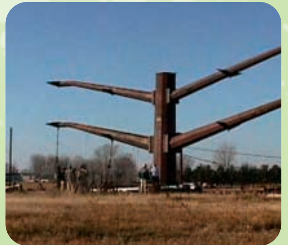
En las instalaciones de prueba de última generación ubicadas en Hager City se realizan pruebas a los soportes de anclaje para cuatro circuitos de alta voltaje. Cada brazo supera los 40 pies (12 m) de longitud y la estructura completa pesa más de 80,000 libras (36,000 kg). Esta nueva conexión de los brazos se probó y se utilizó por primera vez en el circuito de transmisión de Commonwealth Edison de 345kv. El diseño innovador es más liviano pero más resistente, con lo cual se generan ahorros para Thomas & Betts y sus clientes.
